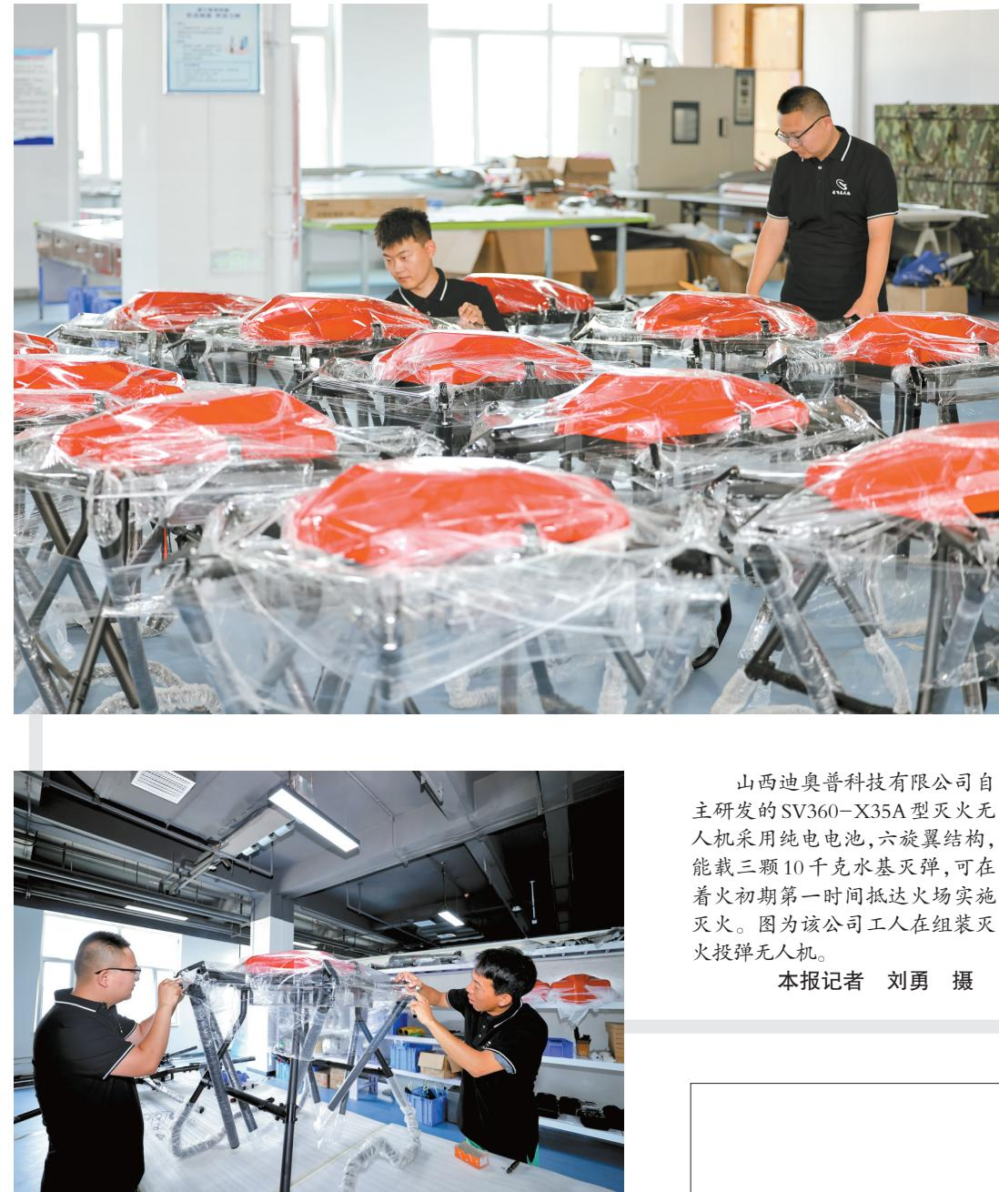
山西迪奥普科技有限公司自主研发的SV360-X35A型灭火无人机采用纯电电池，六旋翼结构，能载三颗10千克水基弹药，可在火灾初期第一时间抵达火场实施灭火。图为该公司工人在组装灭火弹无人机。
