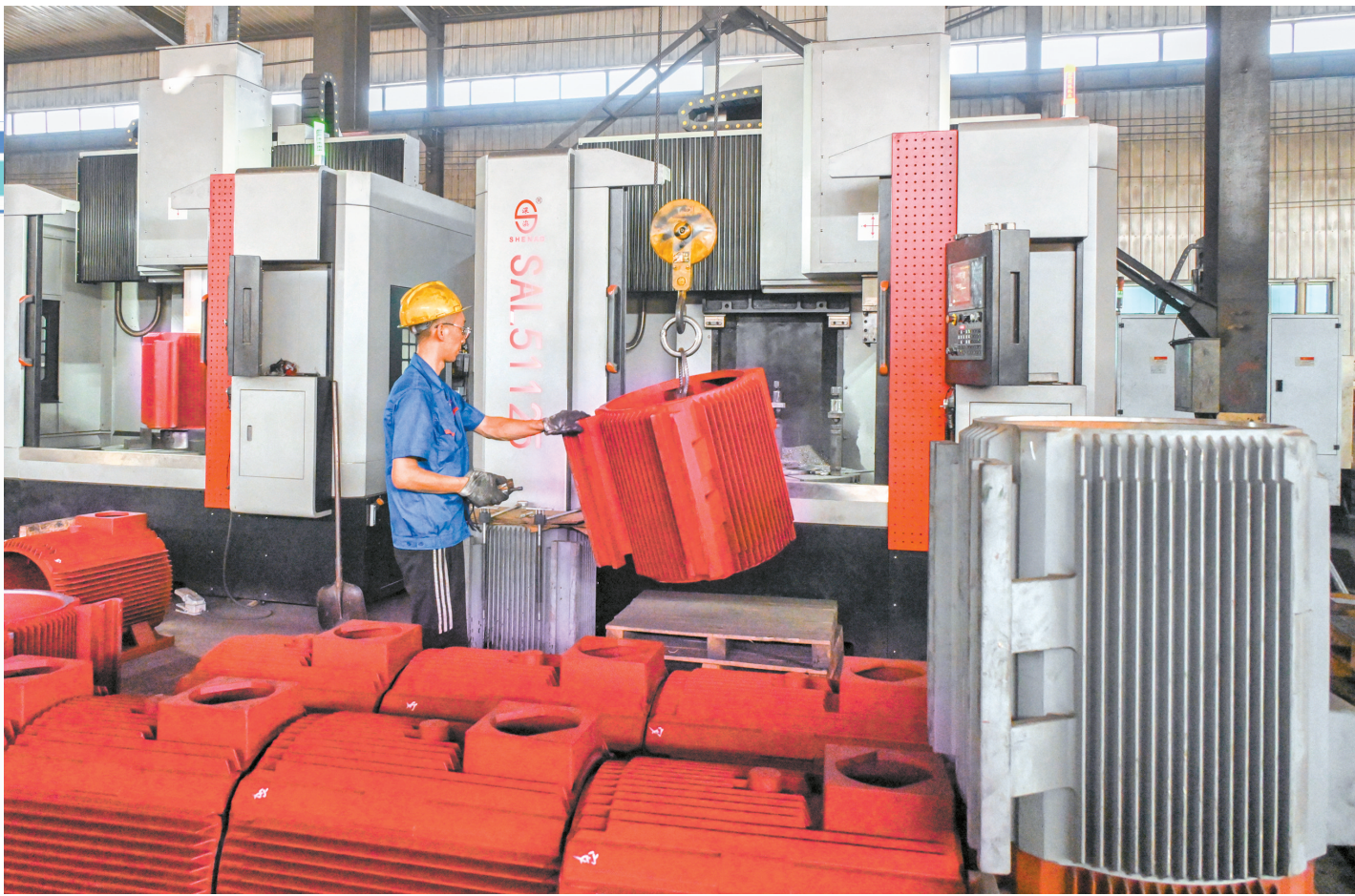
8月27日，山西平遥华丰防爆电机有限公司技术人员在钻铣复合加工中心生产出口订单产品。该企业立足国际市场需求，提高出口铸件加工精度，提升产品质量与合格率，确保出口订单能够及时交付。 本报通讯员 梁生仁 摄
