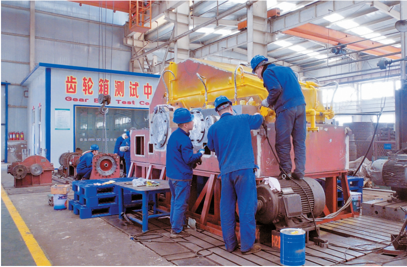
工作人员正在对用龙门式数控镗铣床做出来的新减速器进行最后打磨。马维秀 摄
