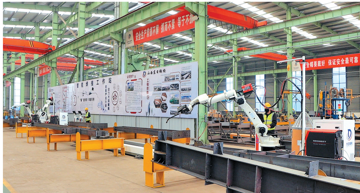
山西东日钢结构工程有限公司生产车间智能焊接机器人。
