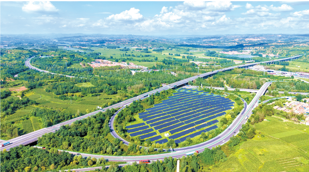
9月6日,二广高速与东吕高速交通枢纽(榆社县城北)车流穿行青山之间。山西交控集团利用匝道闲置土地,建设4.6518兆瓦光伏电站,以“路光互补”模式,推动交通建设与清洁能源协调发展,绘就路网、光伏、乡村相得益彰的生态图景。
