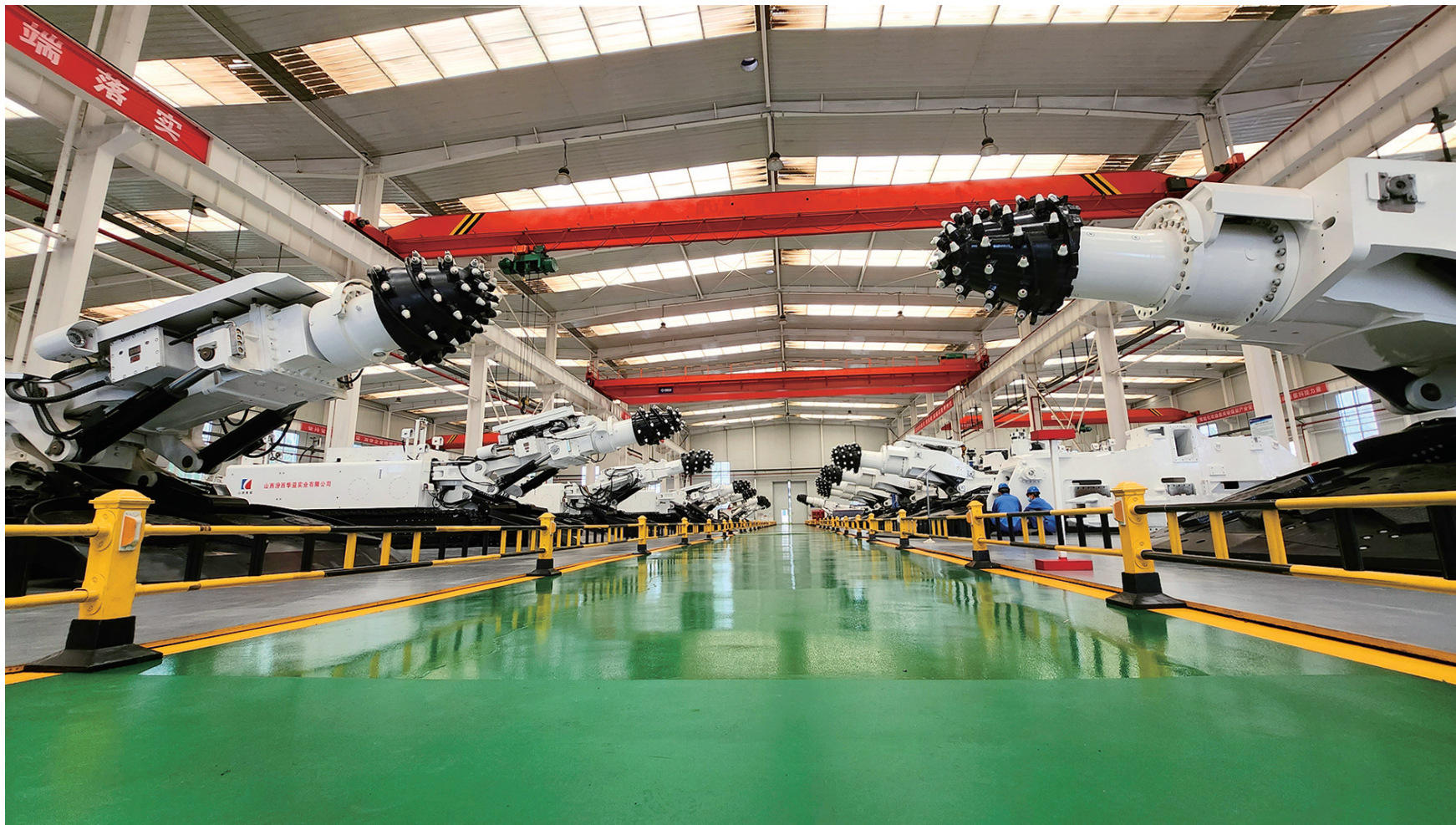
综改区晋中开发区山西汾西华益实业有限公司生产车间里,工人正在对硬岩掘进设备、远程混凝土喷射机和通风管道等设备进行调试。
