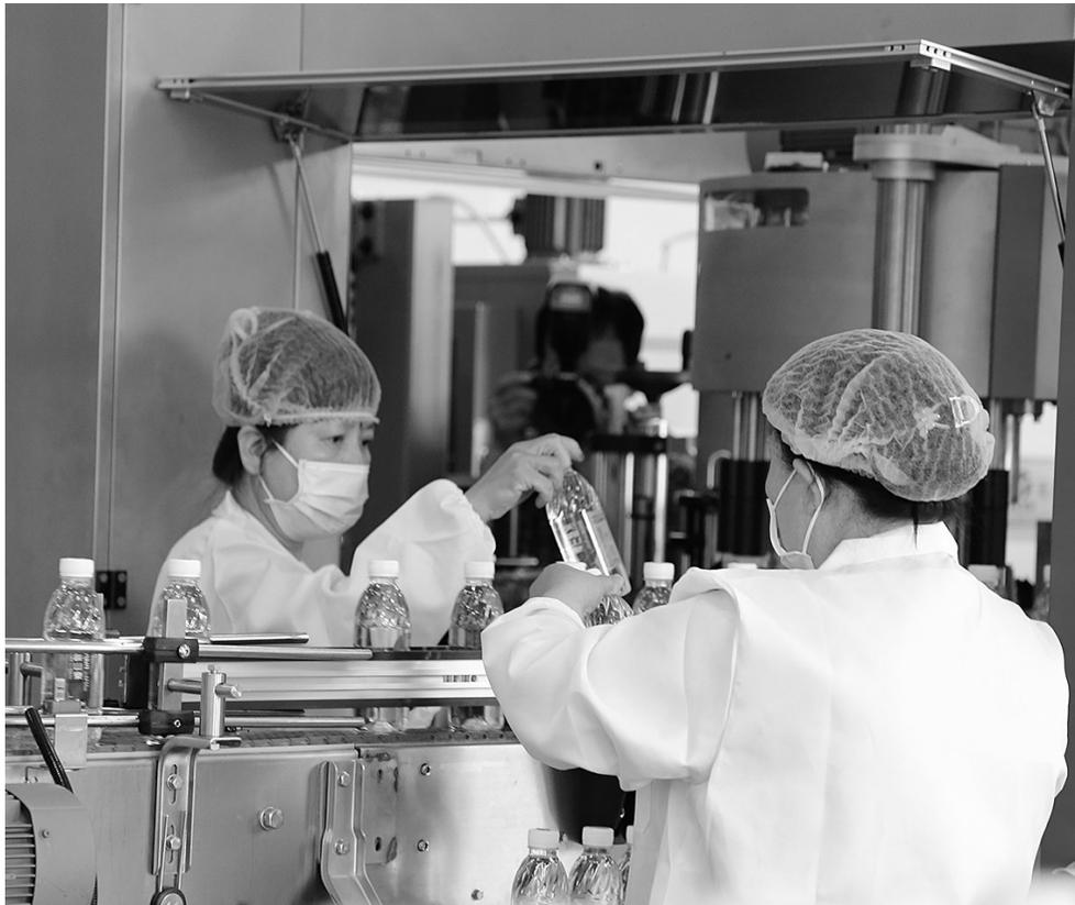
近日，天峻山泉饮品有限公司的工人正在生产线上忙碌，作为介休市连福镇首个天然山泉水生产基地，该公司配备了两条自动化吹灌旋生产线设备，全程只需8分钟，包括吹瓶、灌装、旋盖、贴标、包装和装箱码垛等环节，瓶装水生产线更加智能、高效、环保。图为该公司生产场景。
