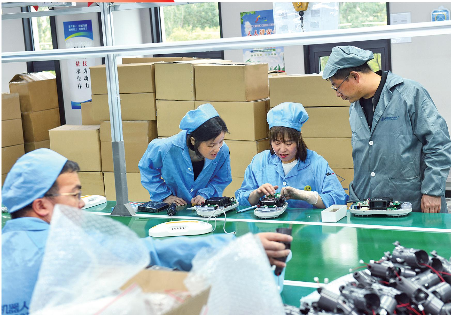
5月12日,山西洒拖机器人技术有限公司生产车间,技术工人正在组装擦玻璃机器人。
