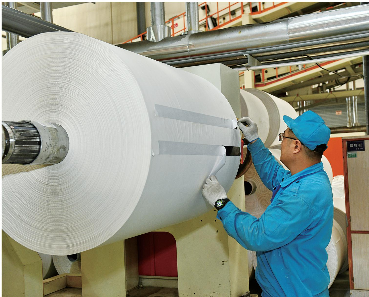
5月21日,山西宇皓环保纸业有限公司生产车间里机器轰鸣,智能化自动生产线上,光滑洁白的石头纸顺滑而出,自动成卷。石头纸是一种新型造纸技术,它的核心原料是碳酸钙,辅以高分子材料和多种无机物,通过特殊工艺加工而成,实现点石成“纸”。山西宇皓环保纸业有限公司坚持转型升级,注重科技创新,不断研发石头造纸新技术、新工艺、新产品,培育新质生产力,增强发展新动能。
