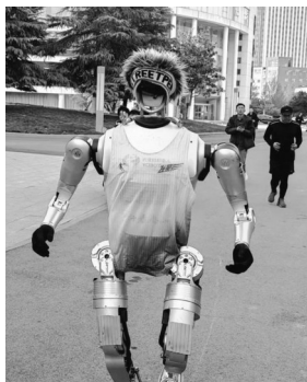
山东优宝特智能机器人有限公司研制的人形机器人“行者泰山”进行马拉松训练。
