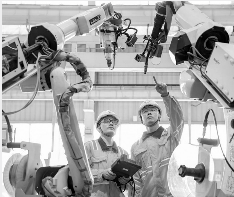
技术人员在调试深水油气装备工艺管线智能生产线的焊接机械臂。
